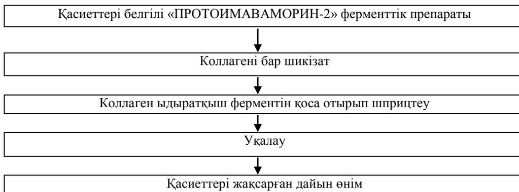
Сурет 1 – Шикізатты өңдеу кезінде «Протоимаваморин-2»-ні пайдалану схемасы
