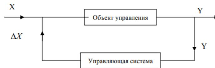
Рис.1 Схема замкнутой системы управления
